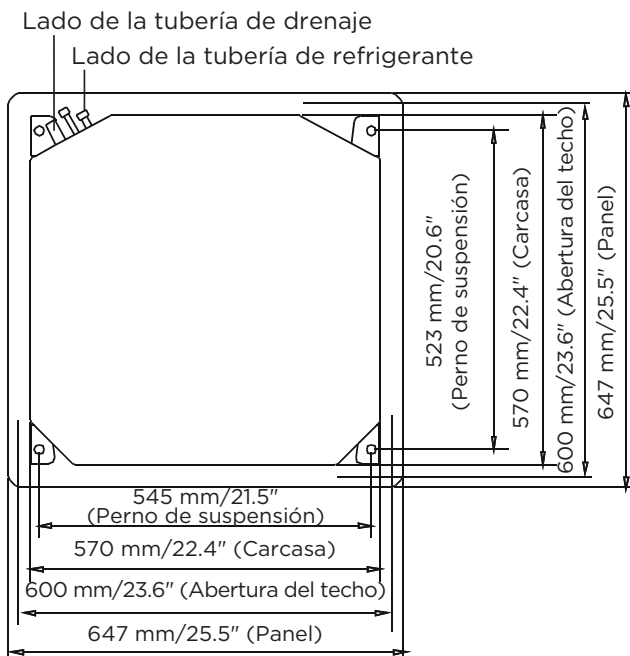
Tamaño de orificio del techo para los modelos compactos
